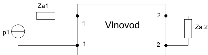
Obrázek 1: Náhradní schema varhaní píšťaly
