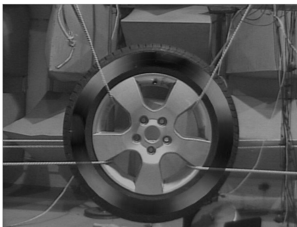
Obrázek 4: Příklad zobrazení tvarů kmitání: 179 Hz, fáze 170°
