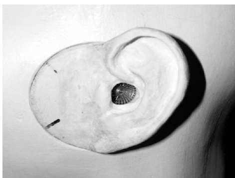
Obrázek 6: Detail umístění měřicího mikrofonu v ušním boltci
