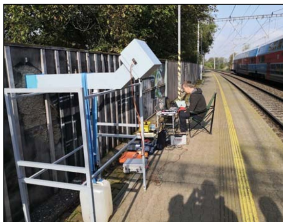
Obrázek 7. Umístění měřených vzorků 6 in situ včetně měřicí aparatury (foceno 2. 10. 2020) [zdroj: ČVUT]
